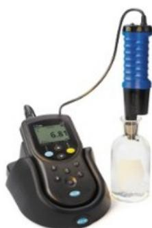
Medidor de DBO
