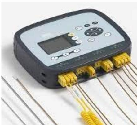
Termómetro Multicanal con Datalogger
