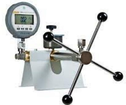
Banco de pruebas con manómetro de alta exactitud
